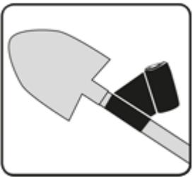
**4** . Enroulez fermement PowerRepair autour de la fracture et de la zone environnante pour créer une bonne étanchéité.
