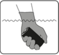
**2** . Ouvrez le contenant hermétique et plongez PowerRepair dans de l'eau tiède pendant environ 15 secondes.
