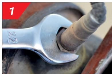
1 Démontez la sonde / le capteur
