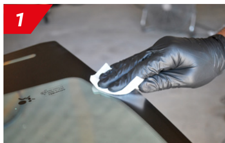
Nettoyer la baie avec la mousse de nettoyage (IT339) et dégraisser avec la lingette (IT341)
