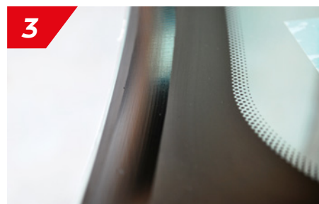
Vérifier que la pellicule de primaire soit sèche et non collant avant de coller
